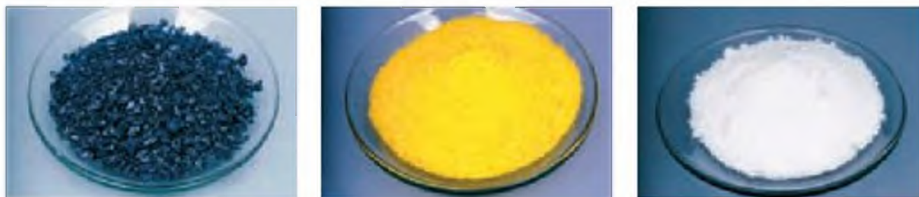
▲ Figura 24.36 Efecto de las transiciones de transferencia de carga. De izquierda a derecha aparecen los compuestos \text{KMnO}_4 , \text{K}_2\text{CrO}_4 y \text{KClO}_4 . El \text{KMnO}_4 y \text{K}_2\text{CrO}_4 son intensamente coloridos debido a sus transiciones de transferencia de carga de ligando a metal (TCLM) en los aniones \text{MnO}_4^- y \text{CrO}_4^{2-} . No existen orbitales de valencia d en \text{Cl} , de manera que la transición de transferencia de carga en el \text{ClO}_4^- requiere de luz ultravioleta y el \text{KClO}_4 es blanco.
